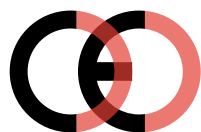
Falsk CE-mærke (for tæt på hinanden)
